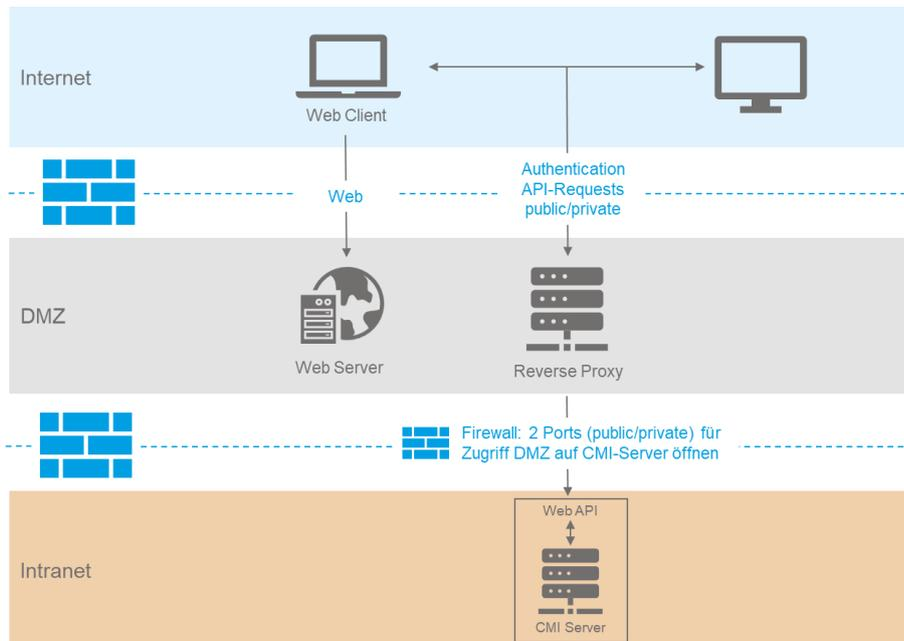
Der Zugriff aus der DMZ auf den CMI-Server wird in der Firewall über 2 Ports (public und private) geöffnet.
