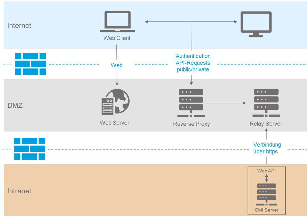
Der Zugriff wird vom CMI-Server zum Relay-Server über https aufgebaut.
